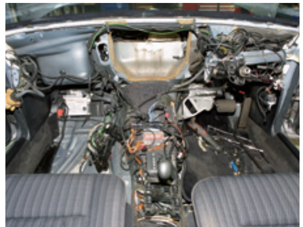
(上) 工賃がかかる部分として代表的なのはエアコン。ダッシュを分解しての作業になるので、部品を交換するだけでも大変。(左) メルセデスに対する深い知識と高い技術を持つセントラルオート。代表の児玉氏を始め、熟練のスタッフがメルセデスのトラブルを的確に解決してくれる。●問い合わせ：☎ 048-930-6800
