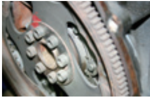
リアのクランクシールからのオイル漏れを起こしている場合、ミッションを降ろさなければシールの交換ができない。
