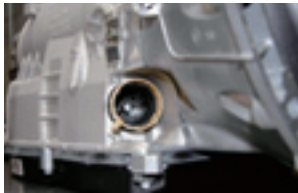
工賃がかかる作業は、付随する作業も同時に行なっておくとい。写真は AT のカバー部分でオイル漏れしやすい。
