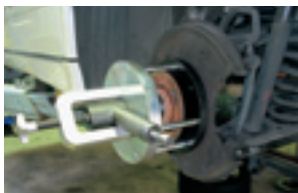
ハブベアリングを交換するための SST。これを使えば効率的かつ確実な交換が可能になる。
