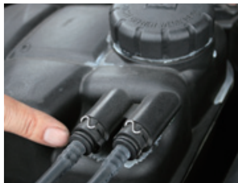
エンジンルームがキレイに清掃されたクルマだと、水漏れなどの痕跡も確認できなくなってしまう。どこから漏れているかが重要なのだ。
