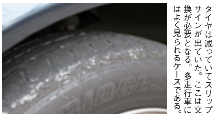
タイヤは減ってスリップサインが出ている。ここは交換が必要となる。多走行車にはよく見られるケースである。
