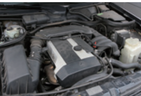
取付車のエンジンは直6DOHC。走行11万kmを超えていてもオイル漏れが見られなかったのは、定期的にメンテナンスされてきた証とも言えるだろう。部品を交換した形跡も数多くあった。
