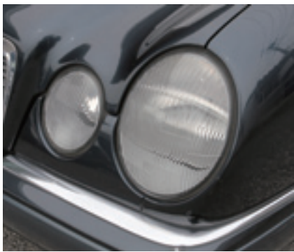
劣化を放置しておくとうつやがなくなりヘッドライトレンズ。取付車はクリアな状態を保っていたことから、定期的にメンテナンスされているのが分かる。
