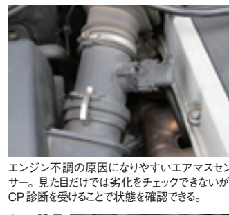
エンジン不調の原因になりやすいエアマスセンサー。見た目だけでは劣化をチェックできないが、CP診断を受けることで状態を確認できる。
