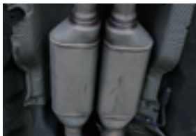
壊れると高くつく触媒だが、W210の場合はそれほどトラブルは多くないという。もし壊れても対処する方法はある。
