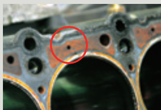
ヘッドガスケットを装着すると、冷却水が通る穴はさらに小さくなる。ここに水垢などが詰まってしまうと、瞬間に水の流れは悪くなる。
