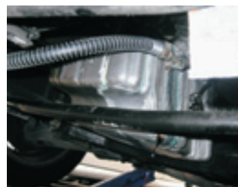
ウォーターポンプから漏れた冷却水がATのオイルパンに付着している。エンジン回りだけでなく、下回りも点検しておくようにしたい。
