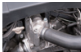
AMG E50用のウォーターポンプを流用している。冷却水の循環をより効率化するために装着したものだ。
