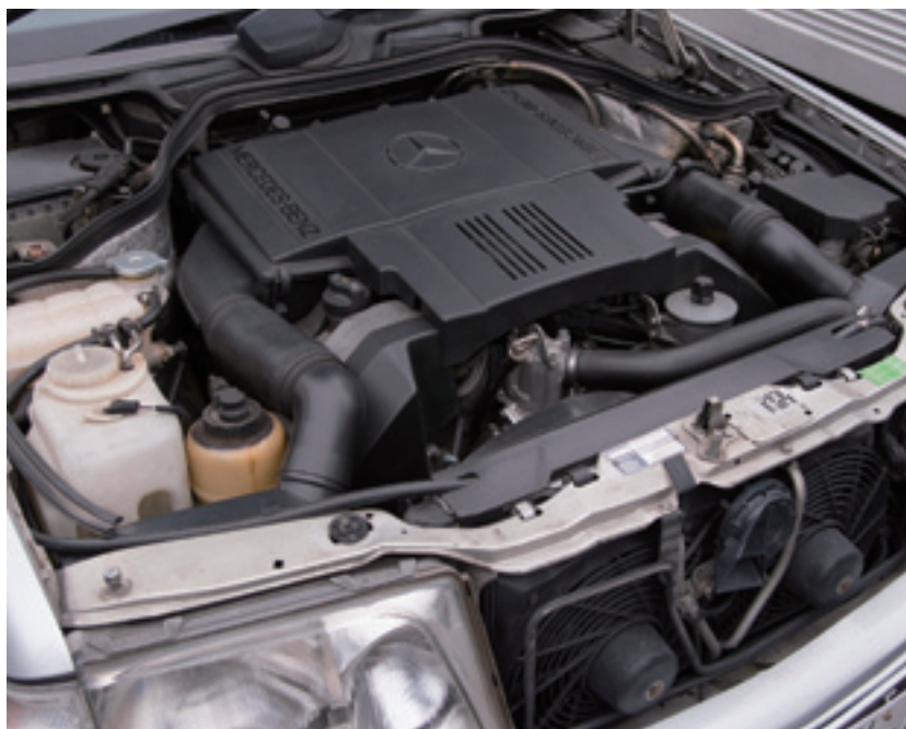
太いトルクでパワフルな加速を実現する名機 M119 ユニートを搭載。きっちりとメンテナンスを行なったら大きなトラブルなく乗れているとのこと。ツボを抑えたメンテナンスで快調をキープしている。
