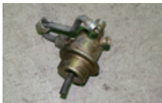
燃料ラインにかかる圧力の上限を決めているのがプレッシャーレギュレータ。古めのクルマではこうした部品のメンテナンスも必要になってくる。
