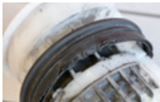
W211などの丸目世代の燃料ポンプはインタンク式。ゴムパッキンが劣化してポロポロになり、フィルターを詰まらせるという事例がある。
