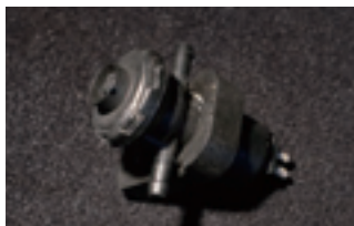
パージバルブにチャコールキャニスタの活性炭が詰まってしまうというトラブルもある。ガソリン臭やエンジン不調の原因に繋がる意外なポイント。
