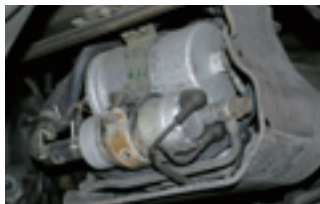
角目世代などを中心に採用されている吊り下げ式の燃料ポンプ。フィルターとともに定期的に交換しておくことが、快調を維持するためには重要。
