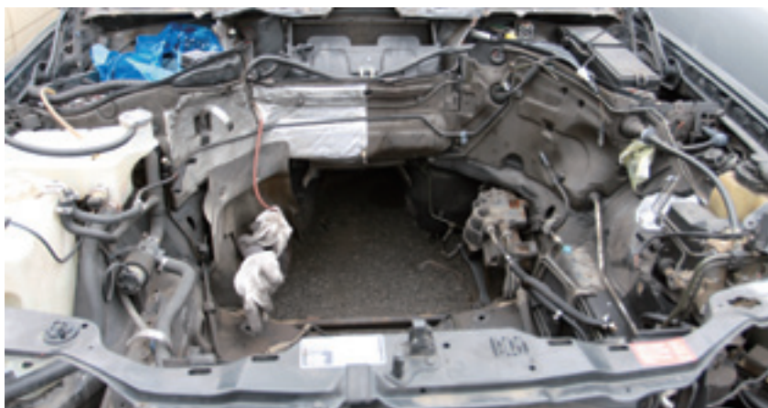
エンジンスワップは作業が大掛かりになり、使用するパーツもベース車両と大きな違いが出てくる。直6エンジンを積むクルマにV8エンジンを積む場合などがそうだ。もちろん、構造変更も必要になる。
