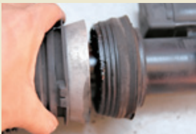
たえず圧力が掛かっている部分なので、ゴム製エアバッグの負担は想像以上に大きい。劣化が進むと亀裂が入り、エア漏れを起こしてしまう。
