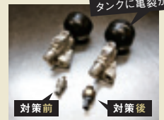
タンクに亀裂が! 対策前 対策後 ABCのバルブには対策品が出ています。グレーのバルブがその対策品だ。対策前のバルブだと高い油圧によってオイルを溜めるタンクが裂けてしまうことがある。
