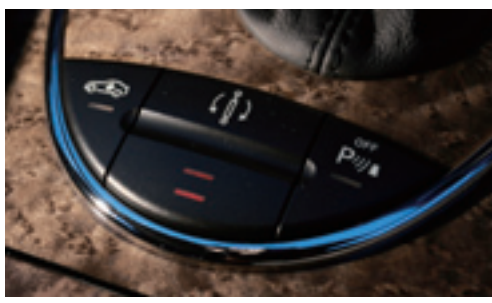
エアサスペンションを搭載するクルマの多くは、室内にあるスイッチで車高や減衰力を任意で変更できる。非常に賢かな装備だ。
