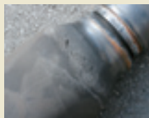
たえず圧力が掛かっている部分なので、ゴム製エアバッグの負担は想像以上に大きい。劣化が進むと亀裂が入り、エア漏れを起こしてしまう。
