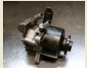
パワステポンプと一体になっている油圧ポンプ。写真はメルセデスのABC。
