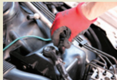
タンクに亀裂が! 対策前 対策後 ABCのバルブには対策品が出ています。グレーのバルブがその対策品だ。対策前のバルブだと高い油圧によってオイルを溜めるタンクが裂けてしまうことがある。
