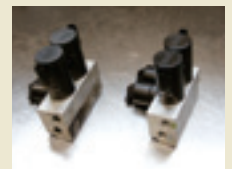
(上) 油圧を左右に分配するコントロールバルブ。メルセデスのABCは4チャンネル制御。(左)メルセデス・ベンツに搭載されるABCシステムの構成部品。
