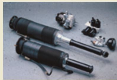
(上) 油圧を左右に分配するコントロールバルブ。メルセデスのABCは4チャンネル制御。(左)メルセデス・ベンツに搭載されるABCシステムの構成部品。
