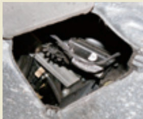
メルセデスのエアマチックに搭載される電動ポンプは約6barの圧力を生み出す。
