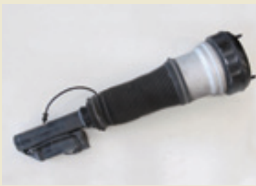
(上) 金属ばねの代わりにエアスプリングを用いた方式。ショックと別になっているのが分かる。 (左) 高級車の多くはショックとエアバッグが一体になっている。
