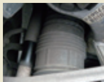
(上) 金属ばねの代わりにエアスプリングを用いた方式。ショックと別になっているのが分かる。 (左) 高級車の多くはショックとエアバッグが一体になっている。
