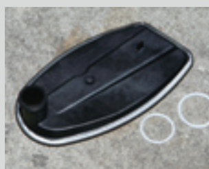
ATFの交換と同時にフィルターを交換しておくことは重要なメンテナンス。作業はそのクルマに詳しい専門店に依頼すること。
