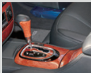
W215型CLクラスやW220型Sクラスで頻発したATシフトが動かなくなるトラブル。内部の部品を対策品にすることで解決できる。
