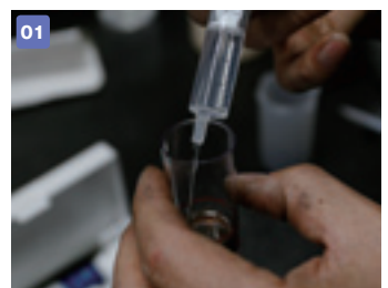
01 クルマから抜き取った ATF を容器に移す。スポイトを使って蒸留水を 5ml 加える。
