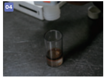
04 5 分ほど経つと ATF が完全に上面に浮き分離。その後、ナトリウム溶液を 10 滴加える。
