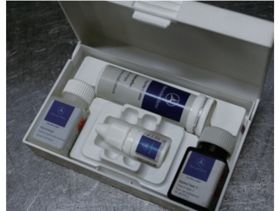
ATF に冷却水が混入していないかをチェックするのが、グリコールテスト。冷却水の混入は大きなトラブルに繋がるのだ。レベルゲージから ATF を抜いてテストを行なう。
