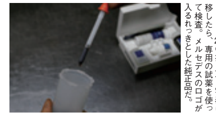
ATF に冷却水が混入していないかをチェックするのが、グリコールテスト。冷却水の混入は大きなトラブルに繋がるのだ。レベルゲージから ATF を抜いてテストを行なう。
