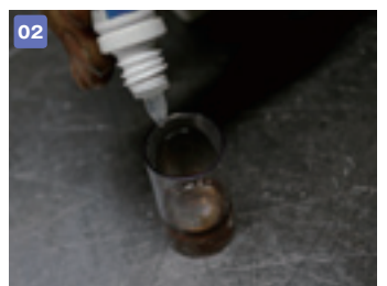
02 グリコールテストキットに含まれている界面活性剤を慎重に 1 滴だけ入れる。
