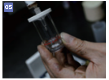
05 3 分待ったら、底の部分の透明な液体だけをスポイトで吸い取り、フィルターでろ過する。
