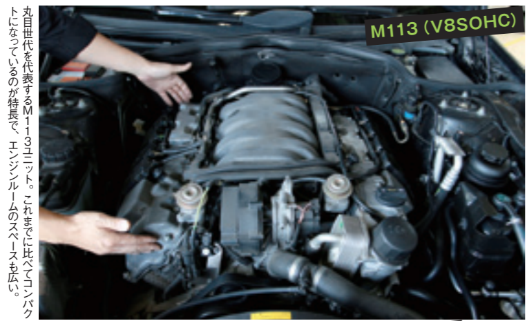
丸目世代を代表するM113ユニット。これまでに比べエンジンルームが激減したことで作業性も向上させている。
