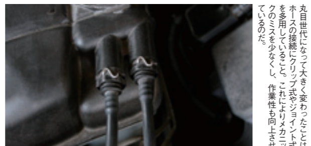
写真はM113エンジンのウォーターポンプ回り。スペースが広く、ラジエター回りもシンプルなので、アクセスしやすい。
