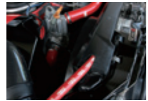
水回りのホース類は耐久性が高いサムコチョイスしている。
