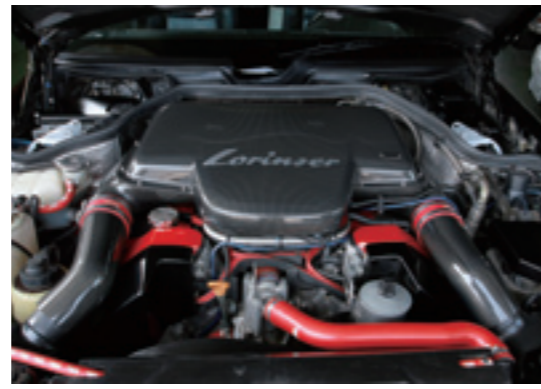
ロリンザーのロゴが入ったカーボン製のカバーが目を引くエンジンルーム。エンジンは腰下をさめたフルオーバーホールが実施されている。
