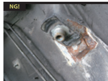
サブフレームとブッシュを外して、ボディのシールを剥がしてみると想像以上にサビが進行していた。
