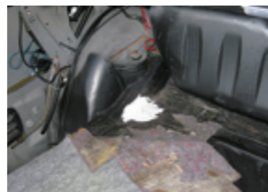
トランク内になるタイヤハウス付近はサビが発生しやすいポイント。しっかりと対策しておくことで、サビの進行を最低限に抑えることができる。
