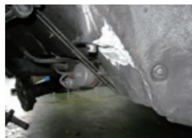
サビをキレイに落として溶接、その後しっかりとサビ止めを塗布して予防する。こうしたボディケアは今後のW124にとって重要なポイントになってくるだろう。
