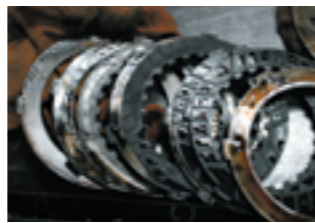
ATのオーバーホールを得意とするセントラルオート。最近ではクラッチディスクだけでなく、クラッチバンドの焼けも多いという。
