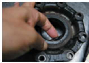
サイド&ミッドシールが劣化することによりオイル漏れを引き起こす。デフオイルはかなり硬めのものが2〜3回必要になる。
