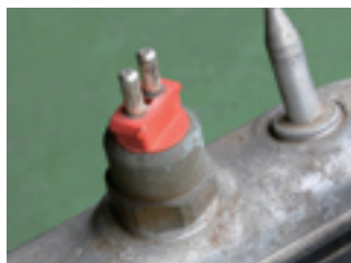
油温を感知するセンサーが小さなラジエターに備わる。これが不良になるケースは少ない。
