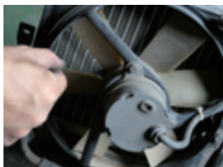
トラブルとして多いのはモーターが焼き付いてファンが回らなくなってしまうこと。
