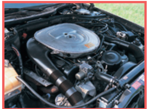
エンジンは SOHC の V8 と直 6 をラインナップ。V8 はエンジン熱の影響が出やすくゴムホースや樹脂パーツの劣化が早い傾向にある。
