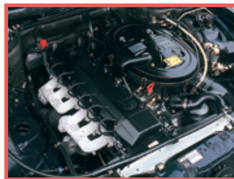
まったりとしたフィーリングを持つ SOHC の直 6 ユニットは KE ジェトロニック式を採用している。整備性が良いのも魅力のポイント。
