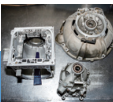
快調に走るためにはエンジンだけでなくATのメンテナンスも必要。ベルハウジング、本体リアケースの3つに分割されているのが特徴だ。
