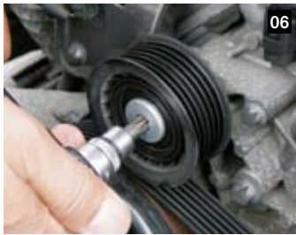
06 後は回してボルトを外し、交換するだけ。カバーは外れていたり、部品のメーカーによっては取り付けられていないこともある。
