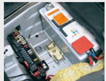
リアシートの座面下にセットされているバッテリー。電機系の作業をする時にはまずマイナス側を外してから。
