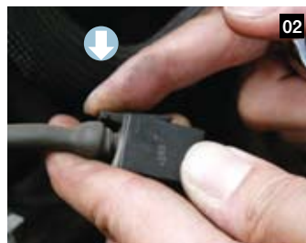
コネクタには矢印の部分にロック機構が備わっているため、ここを掴みながら上方に引っ張る。コードを引っ張るのは×。
