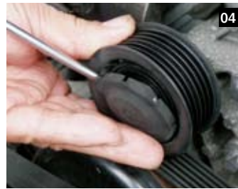
04 アイドラプーリーには樹脂製のカバーが取り付けられているので、マイナスドライバーを使ってこのカバーを外す。
