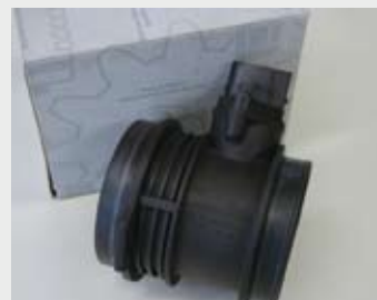
調子の悪いエアマスセンサーを交換した場合、それだけで快調になってしまう場合と、逆に燃調が狂う場合がある。
