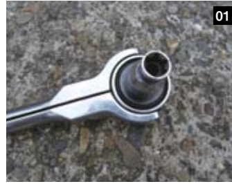
01 ベルトのテンションを緩めるために必要な星形レンチのボックス。これをテンショナーの軸部分に掛けて動かす。
