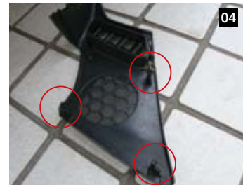
04 スピーカーパネルの裏側。丸印の部分に固定するためのスナップリングがある。2つは樹脂製で、1つは金属製のバネが入っている。
