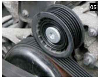
05 カバーを外すと、テンショナーの中心部分に星形の穴が切っただけであるのが分かる。ここにレンチを差し込んで回せば OK。
