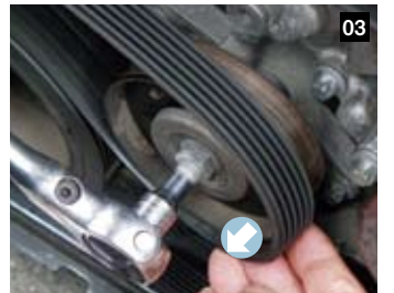
03 テンショナーを引っ張りながら、ローラー部分のベルトを手前にずらせば簡単に外すことができる。
