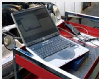
フォルトコードが記憶されてしまうと、診断コンピュータを使ってリセットしないと部品を交換しても直らない。
