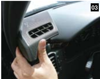
03 3カ所のスナップリングで止められているスピーカーのカバーパネルを取り外す。ここが一番注意を必要とする部分だ。
