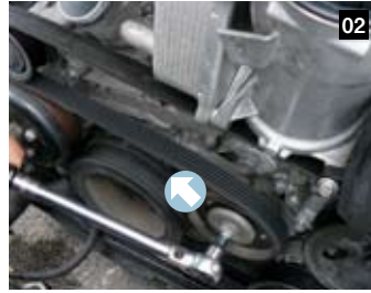
02 テンショナーの星形シャフト部分にレンチを掛け、矢印方向へ動かすことでベルトのテンションが緩められる。
