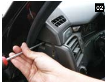
02 ダッシュボードとスピーカーパネルの合わせ目にあるプラスのネジを1つ外す。ここは非常に作業しやすい構造だ。
