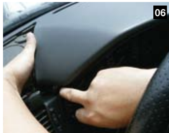
06 外した吹き出し口に指を突っ込むと、メーターユニットの裏側を押すことができる。少し手前に出た方と反対の手でサポート。
