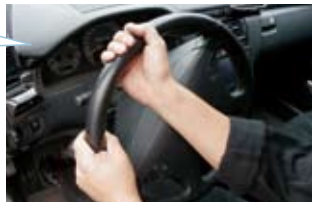
アイドリング状態でステアリングを左右にゆっくり目一杯まで切れば、警告灯はリセットされる。
