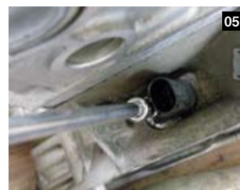
エンジンの上からロングエクステンションを差し込んで固定ボルトを回す。作業スペースが狭いのが難点だ。
