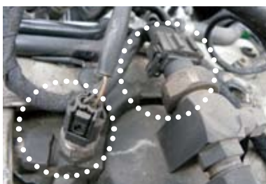
リキッドタンクに取り付けられている圧力センサー。コンプレッサー用と電動ファン用の2つが取り付けられている。
