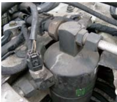
ヘッドライトの裏付近にセットされているエアコンのリキッドタンク。圧縮されて液化された冷媒ガスを一時的に溜めるためのタンクだ。
