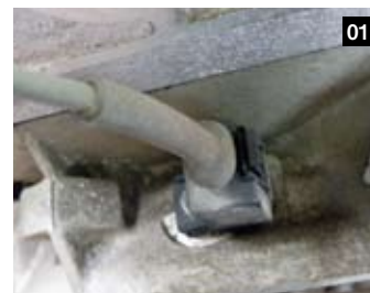
センサーはエンジンの一番後ろ、フライホイールの上に取り付けられている。十分に冷めた状態で手を突っ込んで配線を外す。
