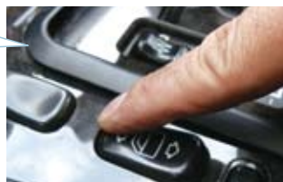
主にオイル交換の時期を知らせるためディスプレイに表示されるスパナマーク。点灯時期は診断コンピュータで任意に設定できる。
