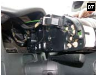
07 メーターを引っ張り出すと、奥にはグレーのコネクタが2つある。ロックを外せば簡単に抜けてくるので、これを外せば完了。
