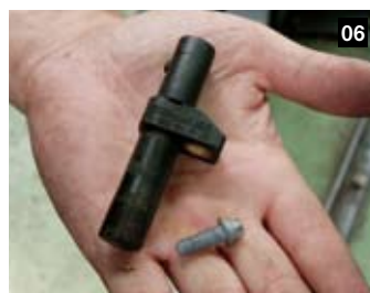
取り外したクランクポジションセンサーと固定用のトルクスボルト。W210にはこのLTタイプの星形ボルトが多数使われている。
