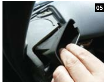
05 カバーの下にあるエアコンの吹き出し口を取り外す。これは差し込まれているだけで固定されていないので簡単。
