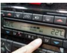
エマージェンシーモードに入ってしまった時は、エラーコードを呼び出して左右のAUTOボタンを動かし押しでリセット。
