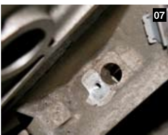
センサーの取り付け穴。単に差し込んであるだけなので、取り付けも非常に簡単。固定ボルトを落とさないよう注意するくらい。
