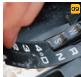
09 ポジションの表示部分はステッカーのように糊で貼られているだけなので、丁寧に剥がせばいい。樹脂製なので破れることはない。
