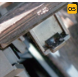
05 パネルのロック機構はこのようなツメ。これが合計4カ所に取り付けられている。よほど無理をしない限り折れることはない。
