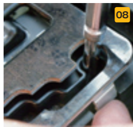
08 シフトのシャフト回りがあるプレートを外す。矢印部分のツメが合計4カ所あるので、上側に浮かすようにロックを外せばOK。
