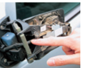
カバーを取り外した状態のドアミラー。指の部分にある針金のようなロックをドライバーの先などで押し外す。ここからは固定ネジを外すだけで取り外せる。
