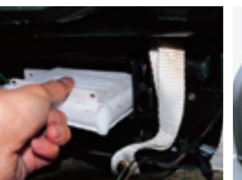
グローブボックスの奥にセットされているエアコンのキャビンフィルター。目詰まりするとプロアーマーに負荷をかけるので、早めに交換しておくのが望ましい。
