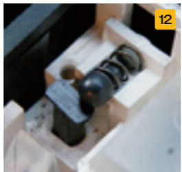
12 スイッチを外すと、その下には節度感を出すためのスプリングと電気的なスイッチを押すためのツマミがある。部品の紛失に注意。
