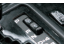
01 シフトノブは二分割構造になっているので、まずは下の部分を回してロックを緩める。指先に力を入れて回せば簡単に外れる。
