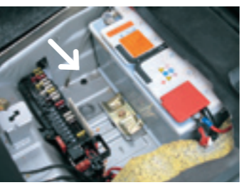
バッテリーはリアシートの座面を外しフタを開けた下に収まっている。この場所なので、交換時には矢印のガス抜きチューブを放出のための穴に繋ぐのを忘れずに。
