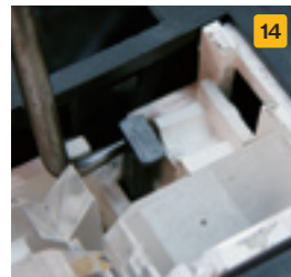
14 ツマミを引き出して、軽く動くように穴やツマミ本体をクリーニング。写真の位置まで飛び出していれば、スイッチは押されにくい。
