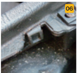
06 コンソール側の受けはこのような構造。この部分にツメが入り固定される。若干弾力のある素材が使用されている。
