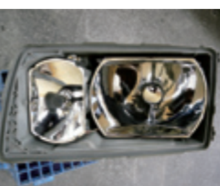
純正パーツ供給がストップしてしまったヘッドライトリフレクター。ヘッドライト ASSY なら現在でも入手可能。分解して清掃をする時は丁寧に扱おう。
