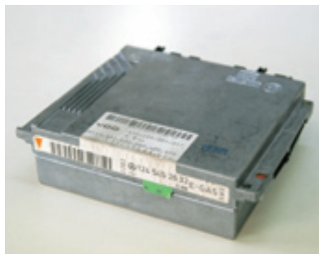
エンジン不調やASR警告灯の誤点灯などのトラブルの原因となっているE-GAS CPUユニットは高価なパーツの一つだ。
