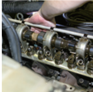
オイル下がりを起こしているクルマが増えている。バルブステムシールの交換などヘッドを開けての作業が必要だ。10万kmに1回は交換しておきたい。
