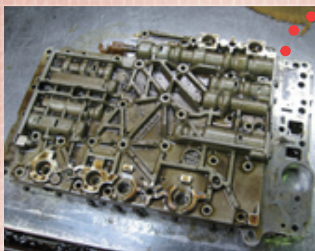
剥がれた摩材がバルブボディを含め、AT全体にこびりついてしまっている。こうなってしまうとオーバーホールしか手はない。
