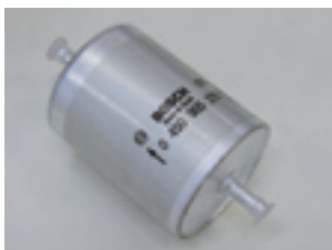
燃料ポンプと同時に交換したいのが燃料フィルター。フィルターだけに定期交換部品であることを認識しておくこと。
