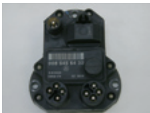
壊れると費用が高つくイグナイター。エンジンが多発する場合は疑うべきポイント。中古品を車内に常備しておく安心だろう。
