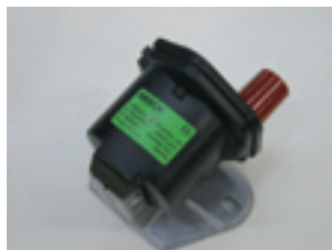
オルタネーターで発電した電圧を増幅する装置がイグニッションコイル。プラグやコードなどの点火系パーツを同時交換しておくべター。
