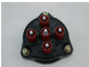
デスピキャップ、ローターは点火系の要となるパーツ。劣化が進むとアイドリング不調になりハンチングなどを引き起こす。
