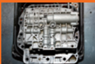
バルブボディを見てみると、3 層式になっているのが分かる。これもこの時代の AT の特徴的なポイントだ。
