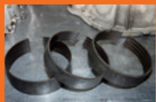
この時代の AT は、3 本のブレーキバンドが使われている。修理業界では通称「3 本バンド」と呼ばれているという。
