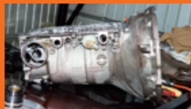
3 分割式だったケースは、本体とベルハウジングが一体になり、車種ごとの専用設計となっている。
