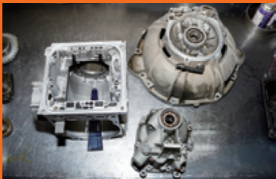
ベルハウジング、本体、リアケースと 3 つに分割されているのが特徴。見玉氏によると AT 本体の材質は良く、混合物が少ないと感じるのだとか。
