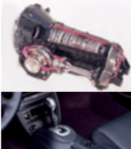
W210 に搭載された電子制御式 5 速 AT は、コンダクタープレートと呼ばれる内部基板の接触不良で、変速しなくなるというトラブルが頻発した。現在では対策品が出ている。
