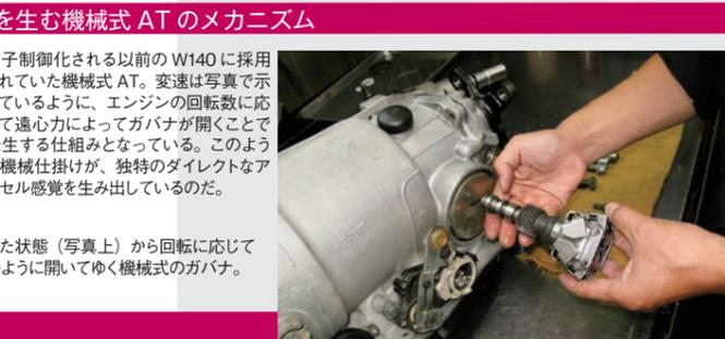
電子制御化される以前のW140に採用されていた機械式AT。変速は写真で示しているように、エンジンの回転数に応じて遠心力によってガバナが開くことで発生する仕組みとなっている。このような機械仕掛けが、独特のダイレクトなアクセル感覚を生み出しているのだ。
