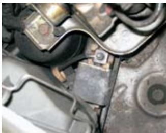
クーリングファンの低速回転を制御するファンレジスター。動いていない場合は、ハンダ付けや配線の作り直しなどを行っている。
