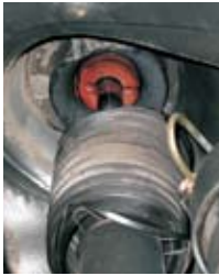
ブーツやパンブラバーが切れているクルマは多い。その時は交換の提案をしているという。
