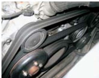
ベルトを張り替える場合はテンションナーやプリーもチェック。ウォーターポンプは回して確認したりもする。
