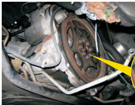
リングギアの奥にあるクラウンクシールは、ミッションを降ろす際にはぜひ同時交換しておきたい部分。2度手間になると当然、工賃も割高になってしまう。
