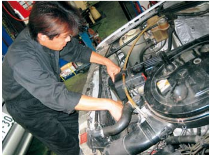
ファンベアリングは、破損すると非常にやっかいな部分。エンジンルームを開ける時には、手を入れてガタをチェックしているという。
