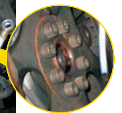
リングギアの奥にあるクラウンクシールは、ミッションを降ろす際にはぜひ同時交換しておきたい部分。2度手間になると当然、工賃も割高になってしまう。
