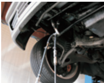
ATFの定期的な交換は必須。同時にフィルターも交換するのがベスト。ATFの交換作業は信頼できるメルセデス専門の修理工場に依頼すること。
